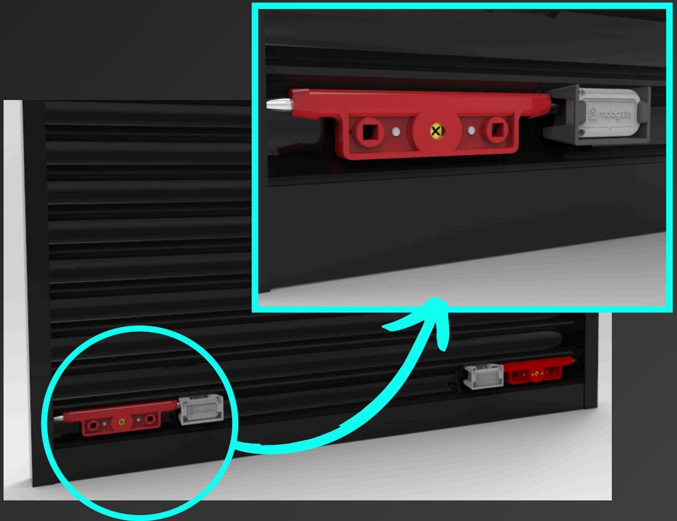
**Para o monitoramento da trava lateral, o sensor deve ser instalado com o suporte, de forma que o ímã entre na parte vazada do suporte quando a trava esteja recolhida. Novamente, o lado reto do sensor deve estar virado para o lado da trava.**
