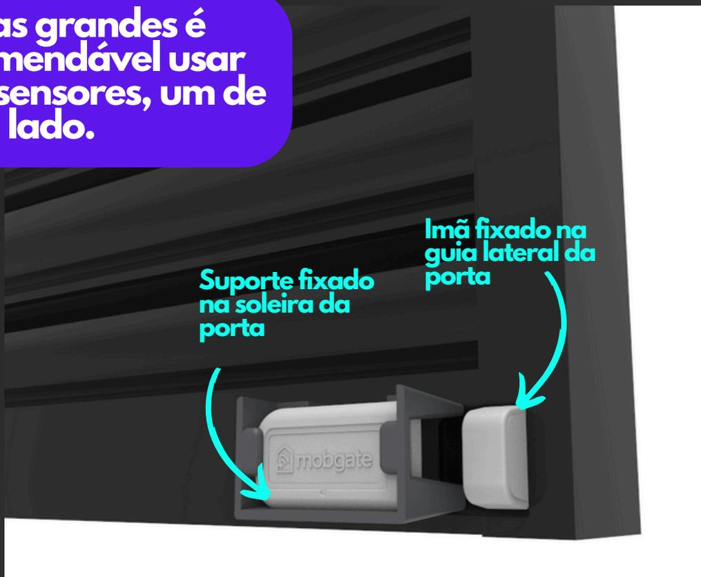
Sempre que os sensores forem fixados em portas metálicas, é importante utilizar o suporte do sensor. A fixação mais distante da massa metálica da porta melhora o desempenho do sistema.
